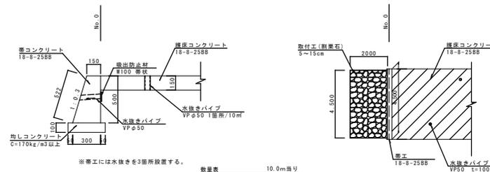
※溝工には水抜きを3箇所設置する。
