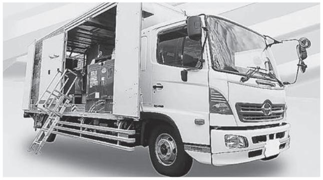
町内3か所の下水処理場の汚泥処理の脱水をする為の脱水機を搭載した車両の購入です。
