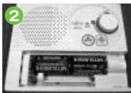
② 乾電池のプラス、マイナスを間違わないようにして、新しい乾電池2本をセットします。(乾電池は、単3から単1まで使用できますが、単1のアルカリ乾電池をおすすめします。)
